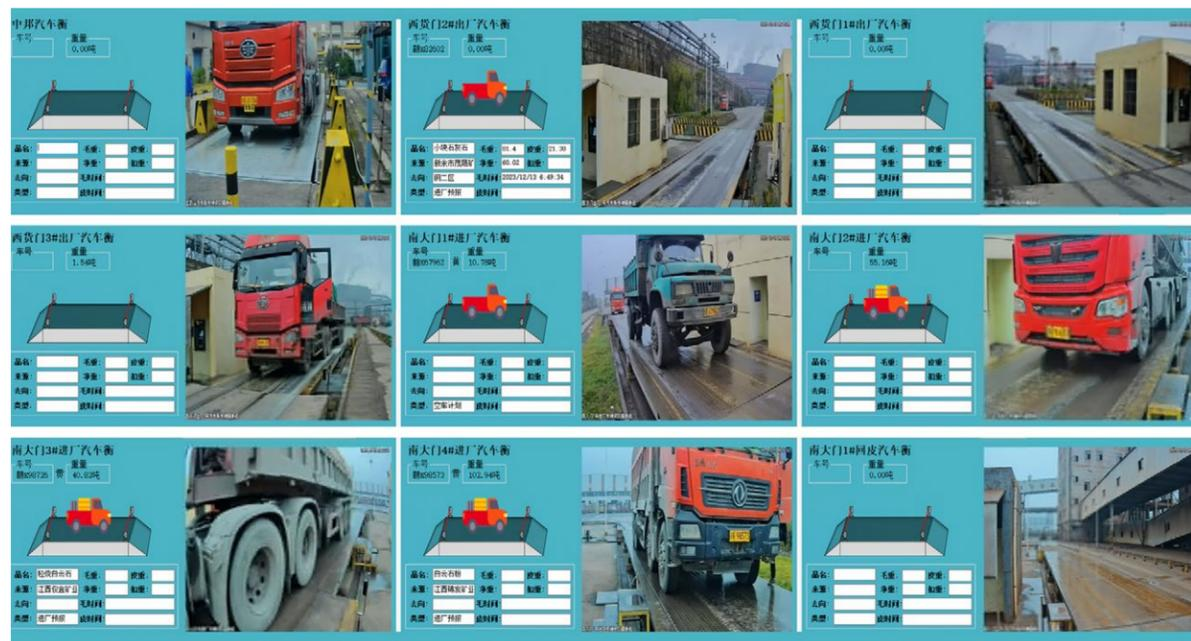
2023 年 6 月，公司汽车衡智慧计量系统正式上线运行，实现了汽车自助进厂、扫码检验、无人计量、线上验收，取得国家软件著作权 4 项。该系统通过对计量业务的整合及流程优化，实现物流、门禁、检验、计量、验收等业务的全流程跟踪和关键业务环节的线上化、少人化、无人化，推动公司物流数字化水平更上一个层次。
